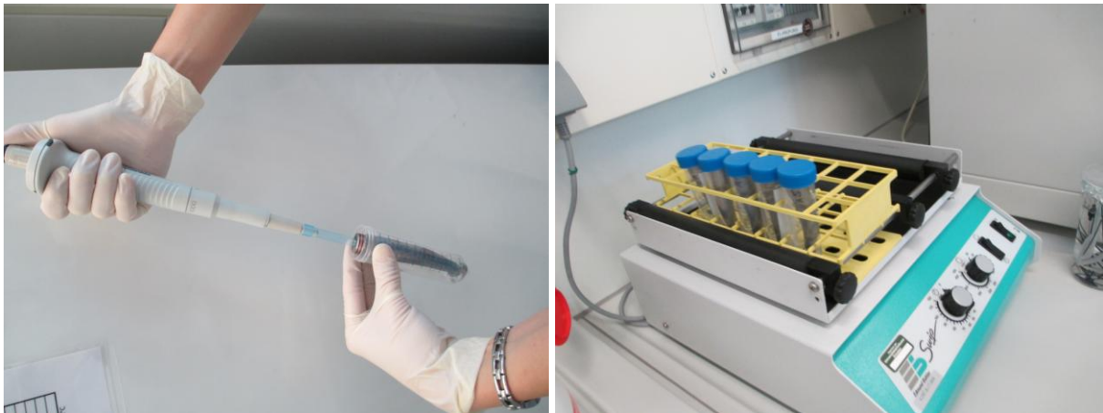
Abbildung 4: Elution von Proteinresten aus den Übertragungsinstrumenten
